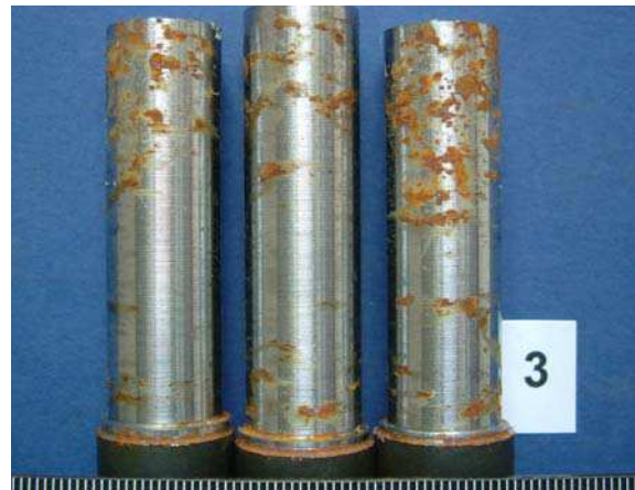
Slika 4.b Uzorci tokareni dodatkom rashladnog sredstva s inhibitorom (nakon 48 h ispitivanja u slanoj magli)
