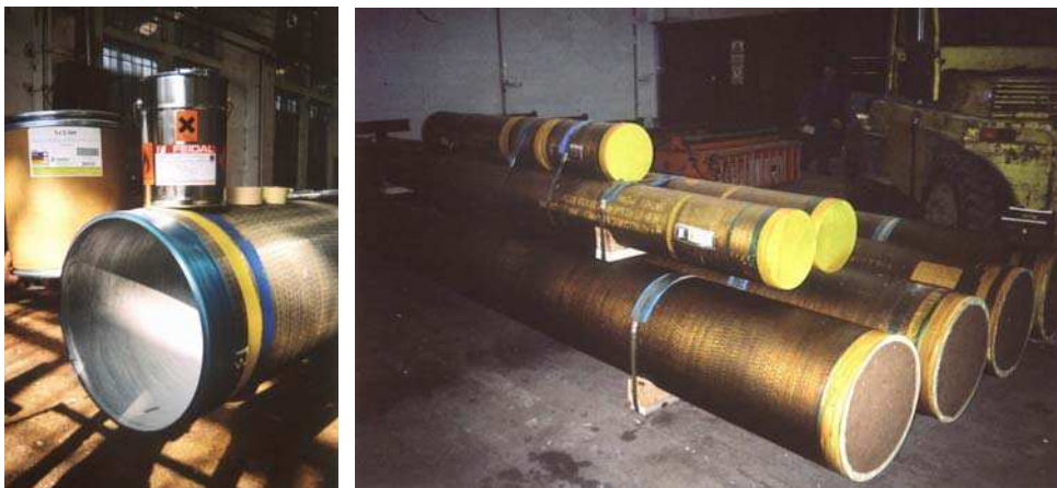
Slika 2. Privremena zaštita unutrašnjosti cijevi praškastim inhibitorima korozije
