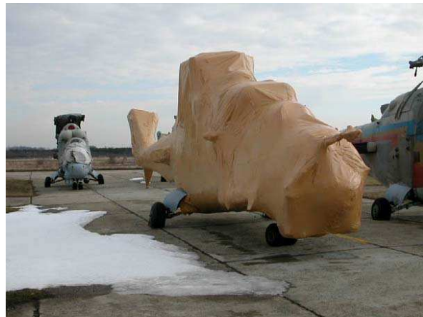
Slika 7.b Primjena inhibitora korozije za zaštitu borbenih letjelica [5]
