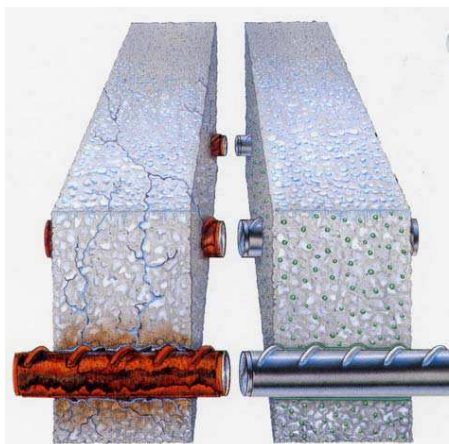
Slika 5.a Primjena migrirajućih inhibitora u graditeljstvu [5]
