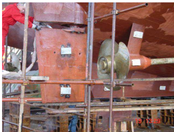
Slika 8.b Zaštita lista kormila VCI-om [5]
