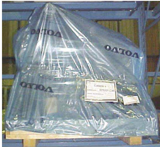
Slika 11.b Oprema zaštićena najlonskim omotom s Cortec-ovim VCI inhibitorom korozije
