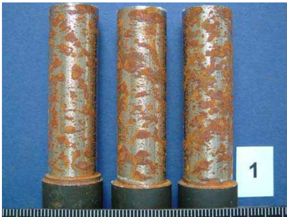
Slika 4.a Uzorci tokareni dodatkom rashladnog sredstva bez inhibitora (nakon 48 h ispitivanja u slanoj magli)
