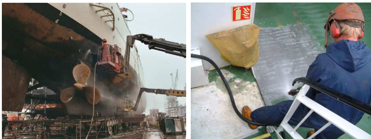
Slika 12. Priprema površine vodenim mlazom [7, 8]
