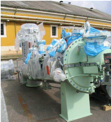
Slika 11.a Zaštita brodske opreme najlonskim omotom bez inhibitora
