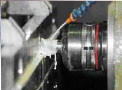
**VpCI-347** je multifunkcionalni inhibitor korozije, sredstvo za hlađenje i podmazivanje pod oštrim režimima rada, kod obrade metala. Kada se koristi prema uputama VpCI-347 omogućuje zaštitu od korozije tijekom obrade metalnih dijelova, skladištenja i transporta čak do dvije godine. VpCI-347 idealan je za zaštitu strojnih i poliranih dijelova, koje je potrebno dugoročno zaštititi od korozije. **VpCI-347** je efikasno rashladno sredstvo u strojevima za obradu metala.
