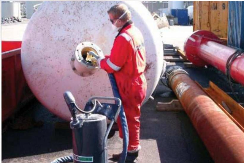
VpCI-308 je hlapivi inhibitor korozije u obliku praha namijenjen za zaštitu neobojenih i obojenih metala od korozije u udubljenim dijelovima, šupljinama i zatvorenim prostorima.
