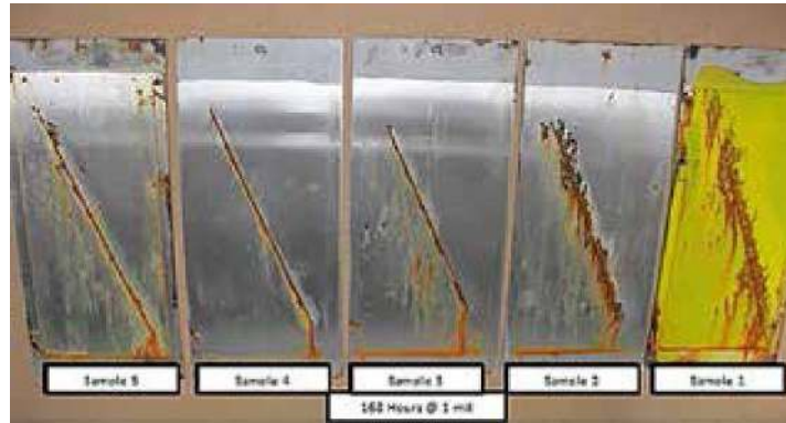
SLIKA 2. Etaloni nakon 168 h u slanoj komori, pojava korozije
