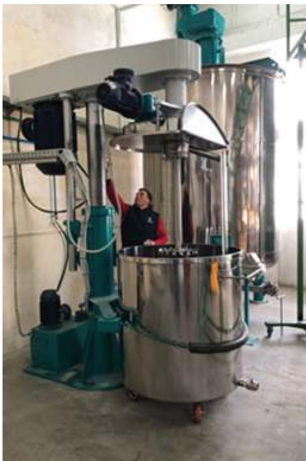
CorteCros® d.o.o. ima proizvodni pogon s proizvodnim kapacitetom od 18 000 litara, kojeg čine miješalica za viskozne tekućine od 3000 litara, veliki spremnik za miješanje od 9000 litara i od 3000 litara, te mala proizvodna linija kapaciteta 3000 litara.
